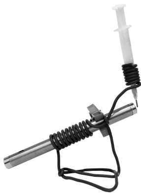
Fot. 1. Wygląd najprostszej wersji zbudowanego mikroskopu.
