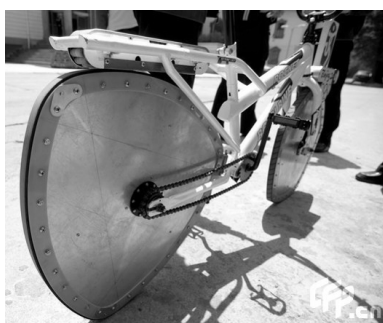
Chiński konstruktor Guan Bailhua nie dał kołu za wygraną i w 2009 roku skonstruował rower o nieokrągłych kołach przystosowany do prostych dróg. Żeby rowerzysta mógł znajdować się na stałej wysokości nad ziemią, zmienił on konstrukcję roweru. Jego rama jest niejako położona na „kołach” (tak jak deska z ludkiem na trójkątach Reuleaux), a nie umocowana do osi obrotu koła jak w standardowym rowerze. Źródło: http://www.china.org.cn/china/photos/2009-05/07/content_17738257_4.htm .
