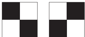
Rys. 2. Cegielki służące do tworzenia udziałów. Białe części są przezroczyste. Jeśli cegielki mają 2 na 2 piksele, otrzymamy udziały o bokach dwukrotnie większych niż szyfrowany obraz.
