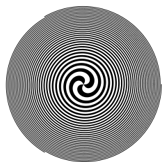
Rys. 2. Binarne spiralne płytki strefowe różniące się liczbą ramion i główną ogniskową.
