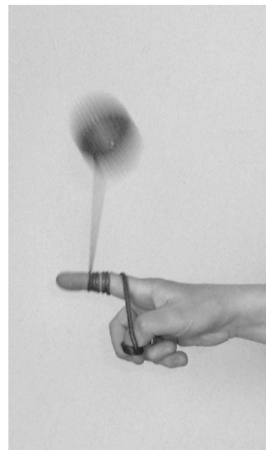
Fot. 6. Ilustracja zasady zachowania momentu pędu przy użyciu elastycznej kuli wodnej.
