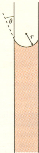
Rys. 3. Woda w rurce kapilarnej, \theta – kąt zwilżania, r – promień krzywizny menisku.
