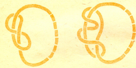
Węzeł ósemkowy (ósemka pojedyncza i podwójna) używany w żeglarstwie do pogrubienia końca liny. Podwójna ósemka może też służyć do niewielkiego skrócenia liny.
