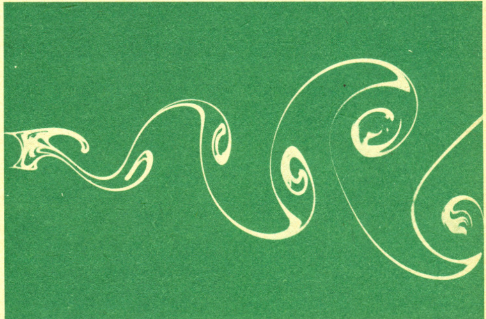
Rys. 6 Ścieżka wirów za walcem (po lewej stronie fotografii) przy R = 140
