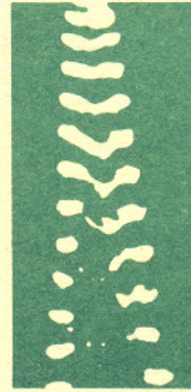
Na rysunku (wykonanym na podstawie zdjęcia z tunelu aerodynamicznego) widoczny jest rozpad ogromnej kropli wody (średnica kuli o tej samej objętości co kropla wynosi 9,4\ \text{mm} ) na dwie duże i trzy małe.
