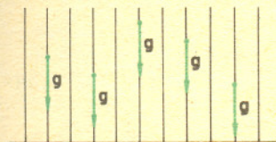
Rys. 6. W jednorodnym polu grawitacyjnym wektor natężenia pola g jest wszędzie taki sam; jeden układ spadający swobodnie z przyspieszeniem a = g jest więc dobrym układem inercyjnym dla całego pola.
