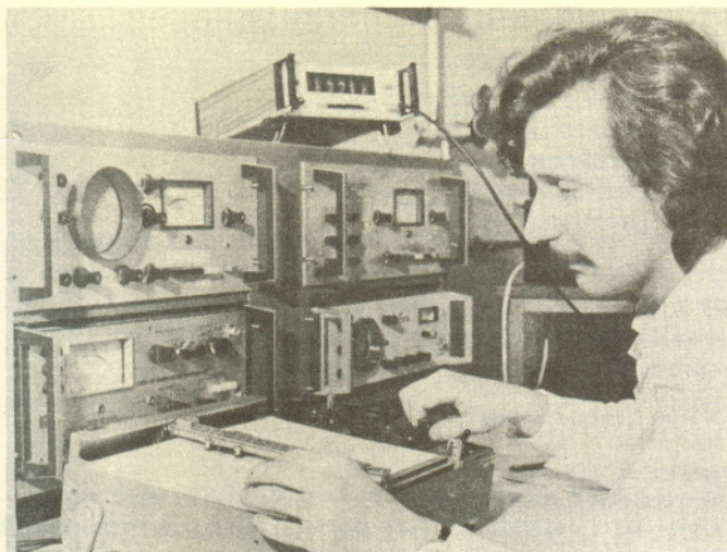
Aparatura do pomiaru jądrowego rezonansu magnetycznego, przy pomocy której uzyskuje się informacje o wewnętrznej strukturze materiałów magnetycznych
