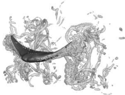
Ryba płaszczka i struktury węzłowe rurek wirowych w wodzie wywołane jej ruchem
