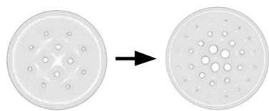
Rys. 1. Kondensat z wirami – widok z góry. Przechodzimy z wolno obracającego się układu (lewa strona) do układu obracającego się szybciej (prawa strona). Liczba wirów, widocznych jako białe, puste przestrzenie, ulega zwiększeniu
