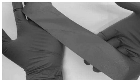
Rys. 4. Warstwa z MXenes do ekranowania fal elektromagnetycznych
