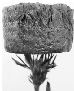
Rys. 2. Aerożel grafenowy, który przy odpowiedniej metodzie produkcji może być lżejszy od powietrza, a mimo to jest w stanie zaabsorbować wodę o masie przekraczającej 850-krotność swojej własnej. Dlatego można go wykorzystać między innymi jako materiał służący do oczyszczania środowiska, ale także do magazynowania energii.
