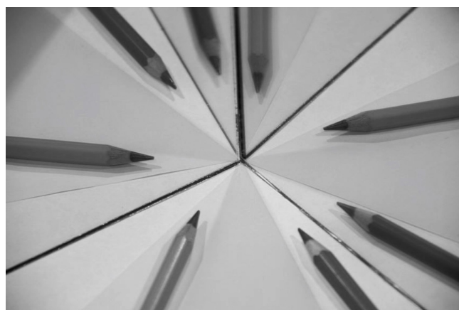
Fot. 2. Kąt między zwierciadłami jest równy \alpha = 100^\circ . Widać po trzy obrazy każdej z kredek. Kredka położona w obszarze zacienionego klina może mieć jeszcze jeden obraz, ale jest on niewidoczny z wybranego miejsca obserwacji.
