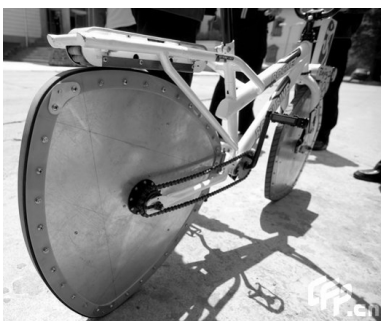
Chiński konstruktor Guan Baihua nie dał kołu za wygraną i w 2009 roku skonstruował rower o nieokrągłych kołach przystosowany do prostych dróg. Żeby rowerzysta mógł znajdować się na stałej wysokości nad ziemią, zmienił on konstrukcję roweru. Jego rama jest niejako położona na „kołach” (tak jak deska z ludkiem na trójkątach Reuleaux), a nie umocowana do osi obrotu koła jak w standardowym rowerze. Źródło: http://www.china.org.cn/china/photos/2009-05/07/content_17738257_4.htm .
