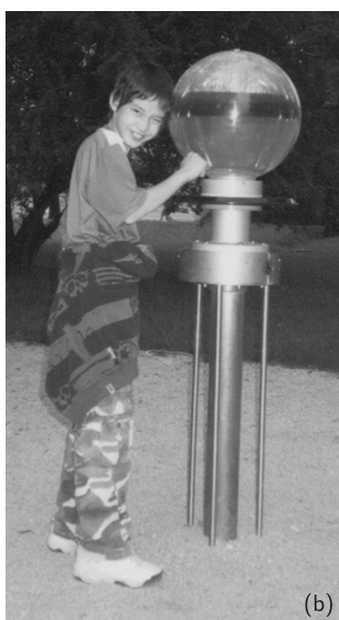
Fot. 1. Przyrządy do badania kształtu powierzchni wody w ruchu obrotowym, zamkniętej w naczyniu: (a) cylindrycznym, (b) kulistym. Oba przyrządy znajdują się w Ogrodzie Doświadczeń im. Stanisława Lema w Krakowie.
