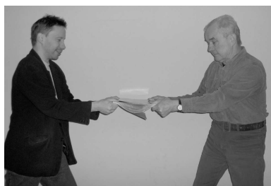
Fot. 1. Siły tarcia między kartkami dwóch książek okazują się tak duże, iż dwie dorosłe osoby nie są w stanie wyciągnąć jednej książki z drugiej.
