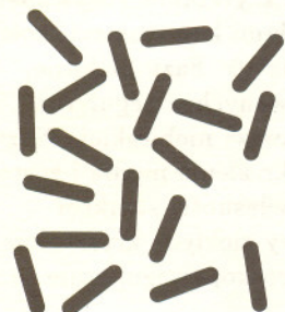
Rys. 3. Struktura izotropowa. Ciekły kryształ podgrzany do odpowiednio wysokiej temperatury traci swój porządek orientacyjny (patrz rys. 2) i powstaje wtedy zwykła klarowna ciecz o typowych własnościach.
