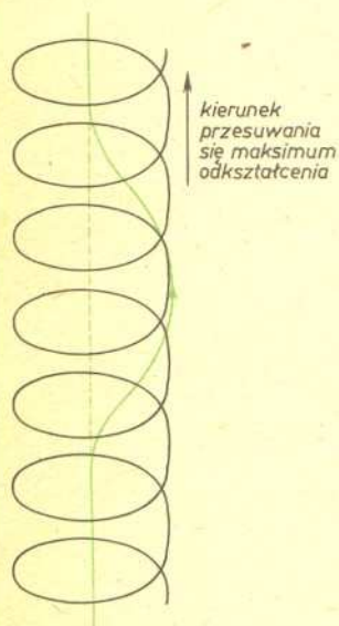
Rys. 2a Fala spiralna — możliwy jest również przeciwny kierunek przesuwania się fali (w dół rysunku) oraz fala stojąca.
