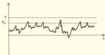
Rys. 10. Ilustracja nagromadzenia się uszkodzeń zmęczeniowych; R_f — tzw. granica wytrzymałości zmęczeniowej.
