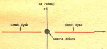
Rys. 9 Przekrój przez czarną dziurę z cienkim dyskiem. Wewnętrzny brzeg dysku ma promień trzykrotnie większy od promienia czarnej dziury, R_g .
