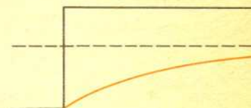
Gleba bardzo przepuszczalna: obniżenie poziomu wody gruntowej zauważalne w dużej odległości
